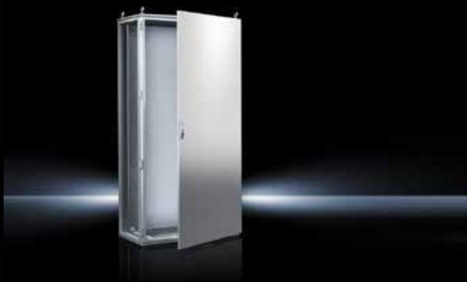
El sistema de ensamblaje TS 8 de chapa de acero ofrece, gracias a su perfil simétrico en anchura y profundidad un claro aumento del espacio y un montaje interior simple. Así mismo se garantiza el ensamblaje hacia cualquier lado. La compensación de potencial automática integrada de todas las piezas planas y el triple tratamiento de la superficie ofrecen una seguridad óptima.
