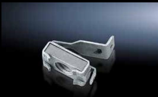
Para armarios y carriles con perforaciones rectangulares de sistema 12,5 x 10,5 mm muelle de presión como ayuda de introducción, unión mecánica y eléctrica en las perforaciones de sistema.
