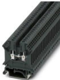
Borne de paso, tensión nominal: 800 V, corriente nominal: 24 A, tipo de conexión: Conexión por tornillo, número de conexiones: 2, sección: 0,5 mm<sup>2</sup> - 4 mm<sup>2</sup>, AWG: 20 - 12, anchura: 5,2 mm, color: gris oscuro, clase de montaje: NS 35/7,5, NS 35/15, NS 32
