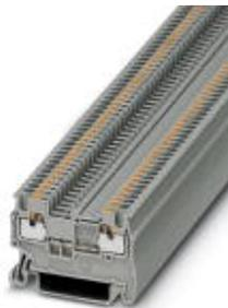
Borne de paso, tensión nominal: 500 V, corriente nominal: 17,5 A, tipo de conexión: Conexión push-in, número de conexiones: 2, sección: 0,14 mm<sup>2</sup> - 1,5 mm<sup>2</sup>, AWG: 26 - 14, anchura: 3,5 mm, altura: 30,5 mm, color: gris, clase de montaje: NS 35/7,5, NS 35/15
