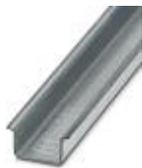
Carril simétrico sin perforar, Perfil estándar, anchura: 35 mm, altura: 15 mm, similar EN 60715, material: Acero, galvanizado, longitud: 2000 mm, color: plateado
